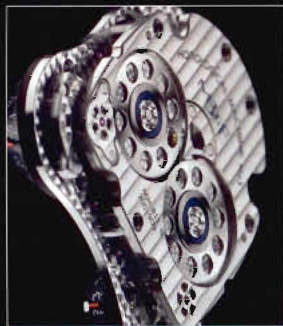
錶背上的兩個大型齒車由滾珠軸承支撐，不但讓機芯變薄，也有最好的摩擦特性。
